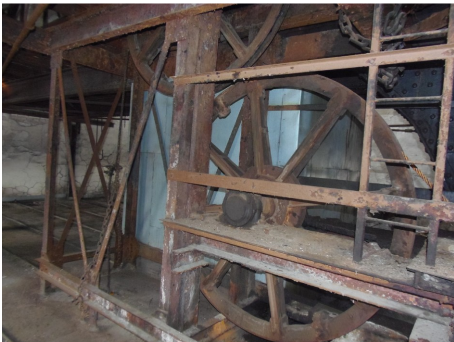
Obr. č. 19: Lanovnice malého těžního oddělení.
